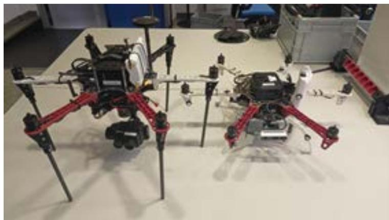
identifie les points chauds potentiels, tandis que la caméra RVB vérifie les défauts tels que les ruptures ou les fissures susceptibles d'avoir provoqué une surchauffe.
